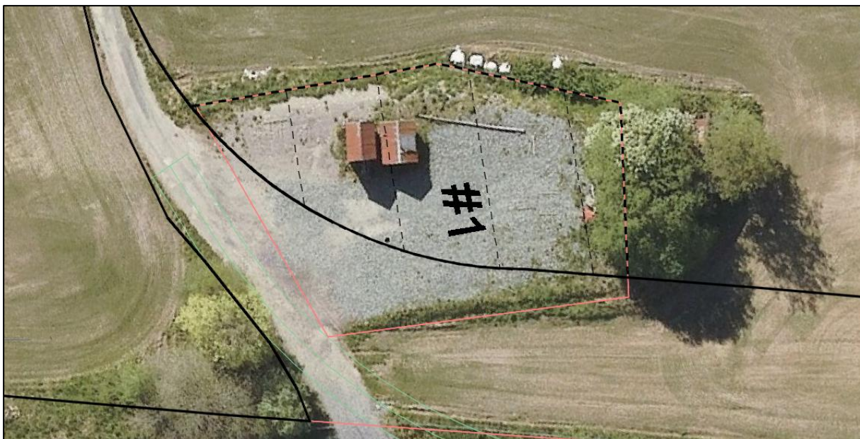
Figur 2: Utsnitt av areal foreslått som midlertidig bygge- og anleggsområde. Som figuren viser så er dette et gruslagt område, trolig brukt til rigg- og drift ifm. tidligere jernbaneutbygging på Ler. Deler av arealet/festeeiendommen ligger også innenfor regulert jernbaneformål.
