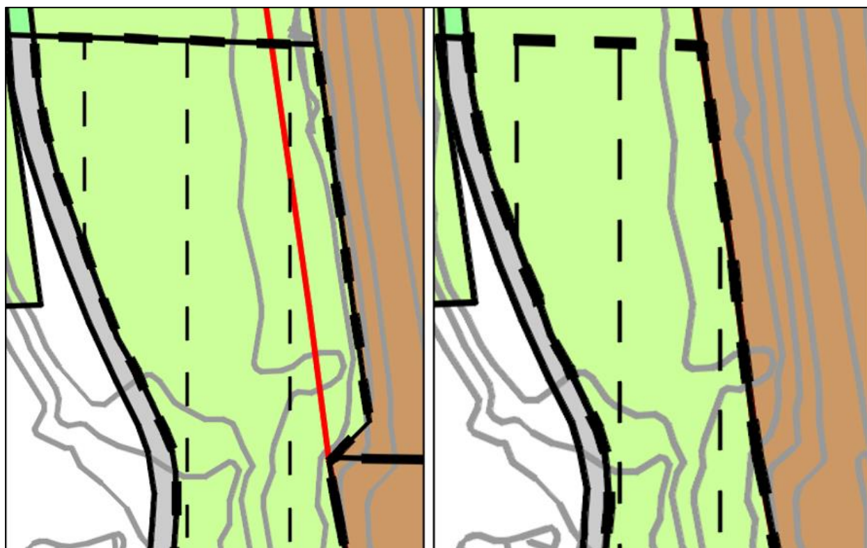
Figur 17: Endringspunkt 8: Dagens regulering (venstre) og forslag til endret regulering (høyre). Det er gjort en justering av jernbaneformålet i tråd med eiendomsgrense/faktisk situasjon.
